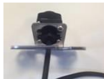
Kamera obrócona o 180° w oprawie
